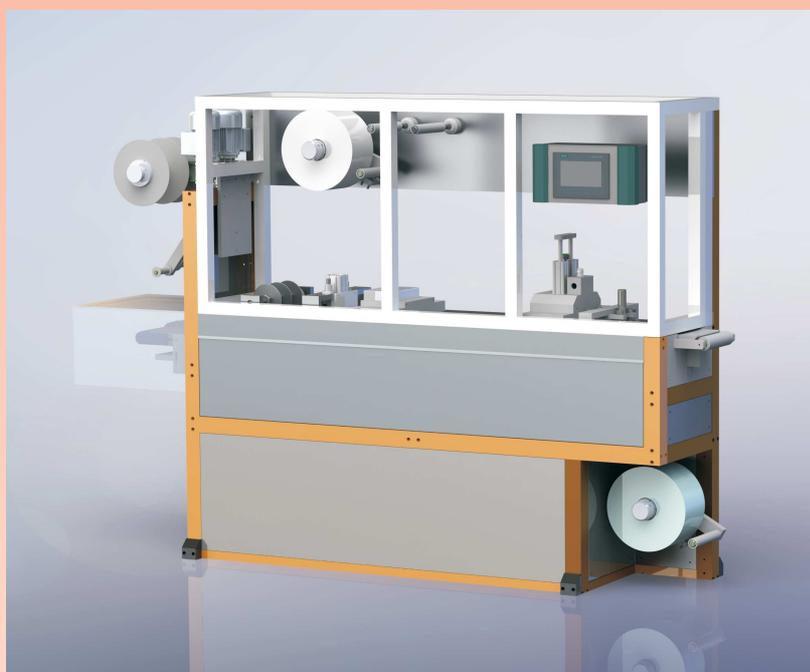
Pocket Blister è configurabile con diversi optional, quali : sistemi di carico automatico o carico manuale, nastro di scarico, sistemi di avvolgisfrido, diversi tipi di stampanti.
